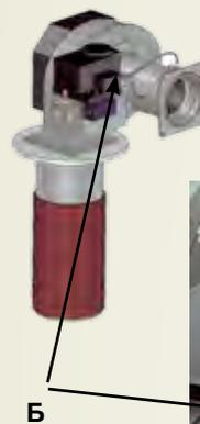
Рис.6 Регулировка параметров CO<sub>2</sub> при мин. мощности
