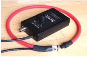
Рис. 8. Катушка с соединением встык зажимным фитингом и с автономным интегратором фирмы RogoCoil
