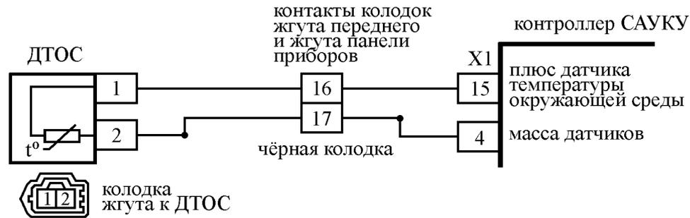
**Код В1347****Цепь датчика температуры окружающей среды замкнута на "массу"**
