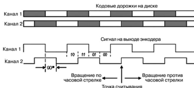
Рис. 2. Выходные сигналы энкодера
