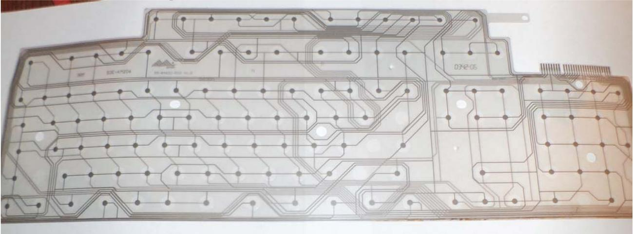
3. Ищем повреждённые участки клавиатуры и находим. С помощью тестера убеждаемся, что это действительно повреждённые части. Повреждённые части выглядят потемневшими. В нашем случае две дорожки повреждены.
