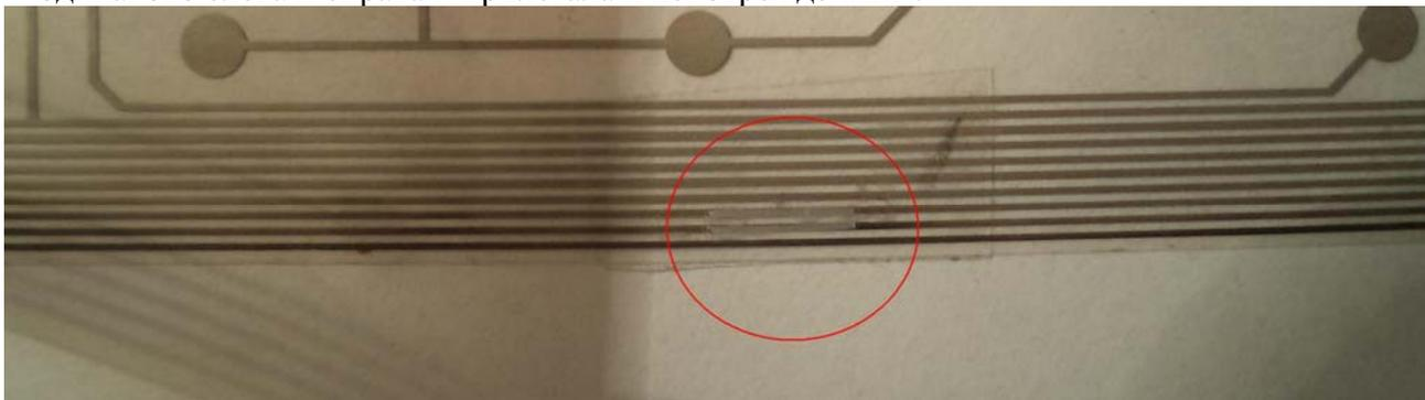
Проверяем оставшуюся часть плёнок на наличие повреждённых элементов, восстанавливаем их аналогичным способом, собираем клавиатуру и продолжаем пользоваться.
