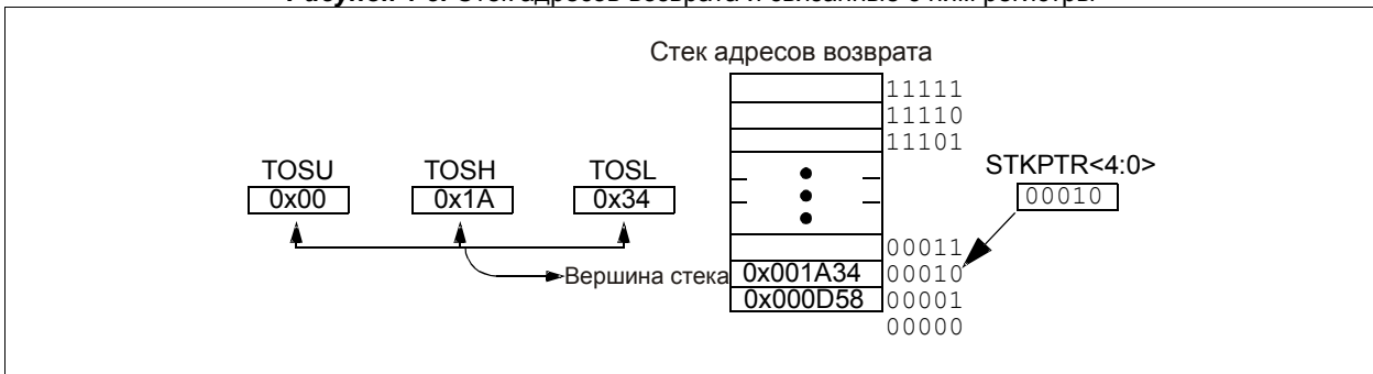
Рисунок 4-3. Стек адресов возврата и связанные с ним регистры
