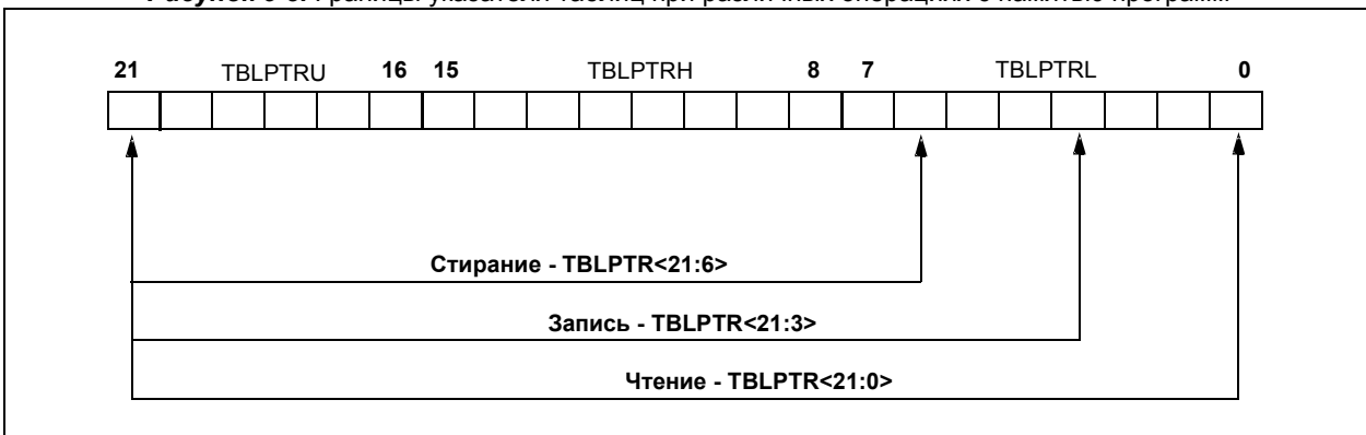
Рисунок 5-3. Границы указателя таблиц при различных операциях с памятью программ
