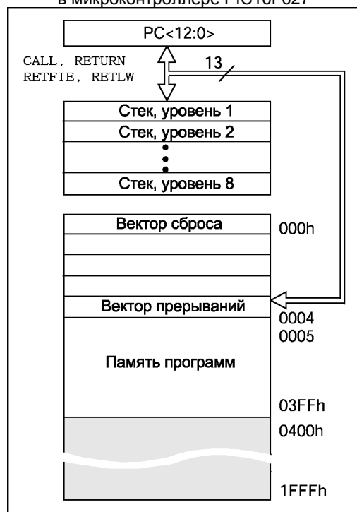
Рис. 4-1 Организация памяти в микроконтроллере PIC16F627
