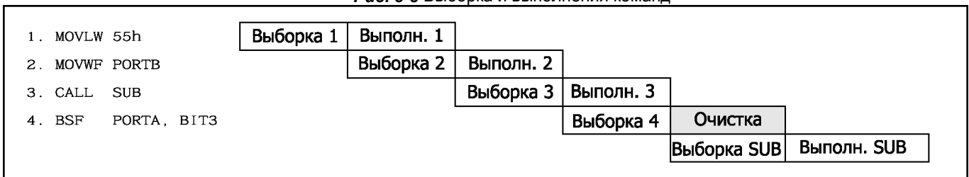
Рис. 3-3 Выборка и выполнения команд
