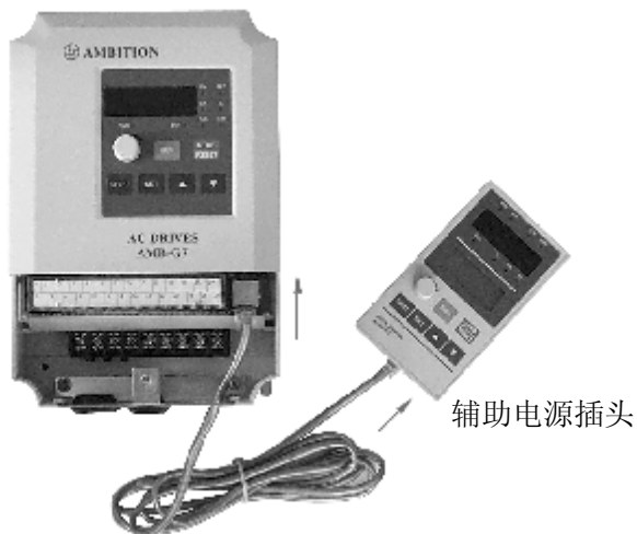
图 2-5 远控键盘、延长电缆和端子连接
