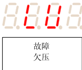
图 6-2 LED 和 LCD 上电欠压显示
