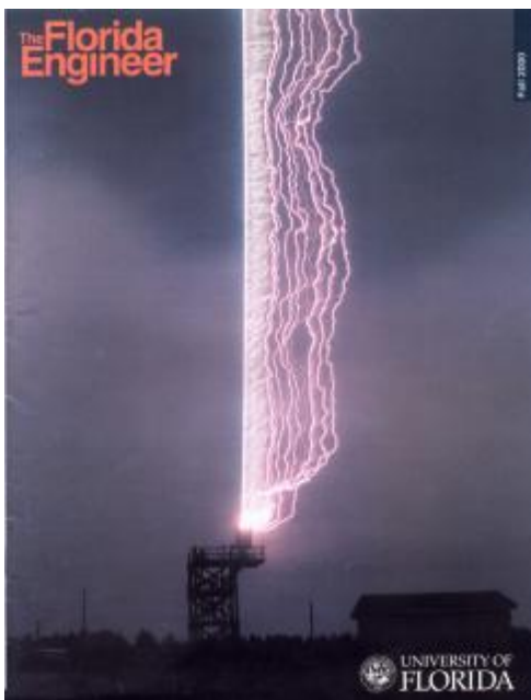
Рис.1.4. Серия из 11-ти компонентов триггерной молнии, инициированная ракетой, запущенной со стационарной пусковой установки (видимая по вертикали длина канала ~60м)
