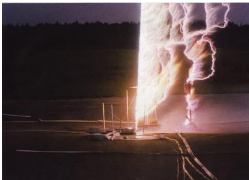
Рис.1.6. Серия разрядов триггерной молнии, инициированная ракетой, запущенной из подземной пусковой установки
