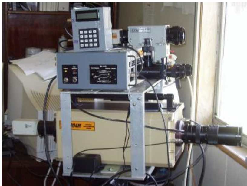
Рис.2.1. Камера К004М на нижней платформе штатива, камера К008, фотодатчик ФД001 и устройство блокировки на верхней платформе
