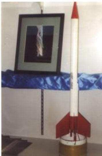
Рис.1.1. Ракета длиной около 1м с катушкой провода на хвосте, используемая для инициирования молнии
