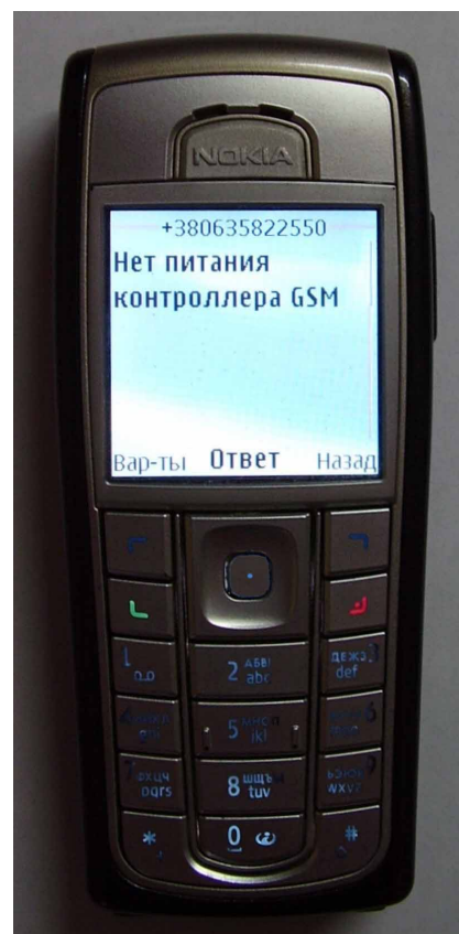
Рис. 8. Принятая PDU посылка от ATtiny на экране телефона
