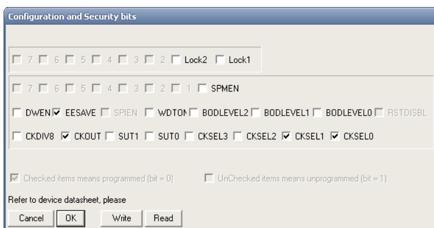
Рис. 6. Конфигурация "фьюзов" контроллера ATtiny
