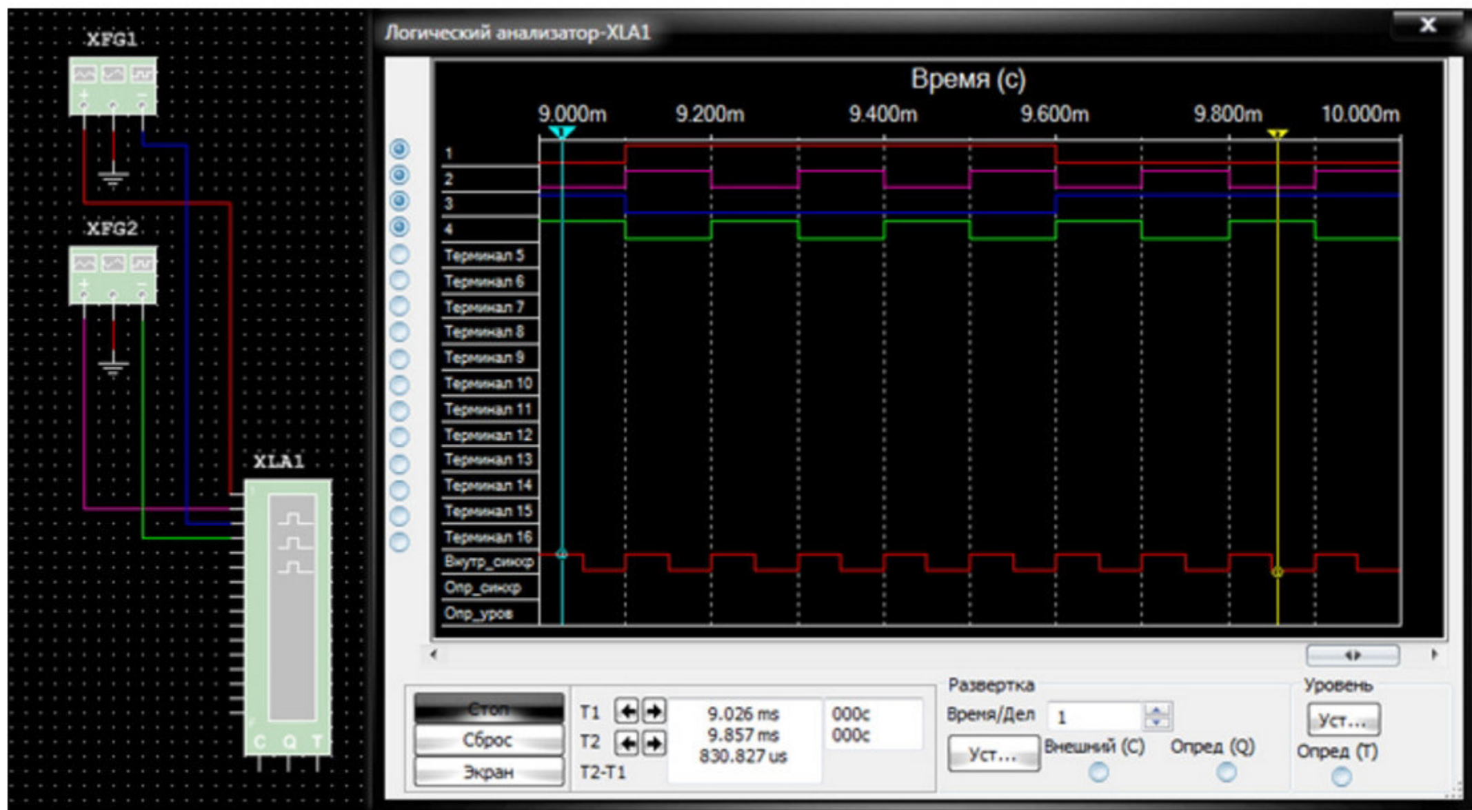
Рис. 1. Пиктограмма логического анализатора, подключение к схеме и его лицевая панель
