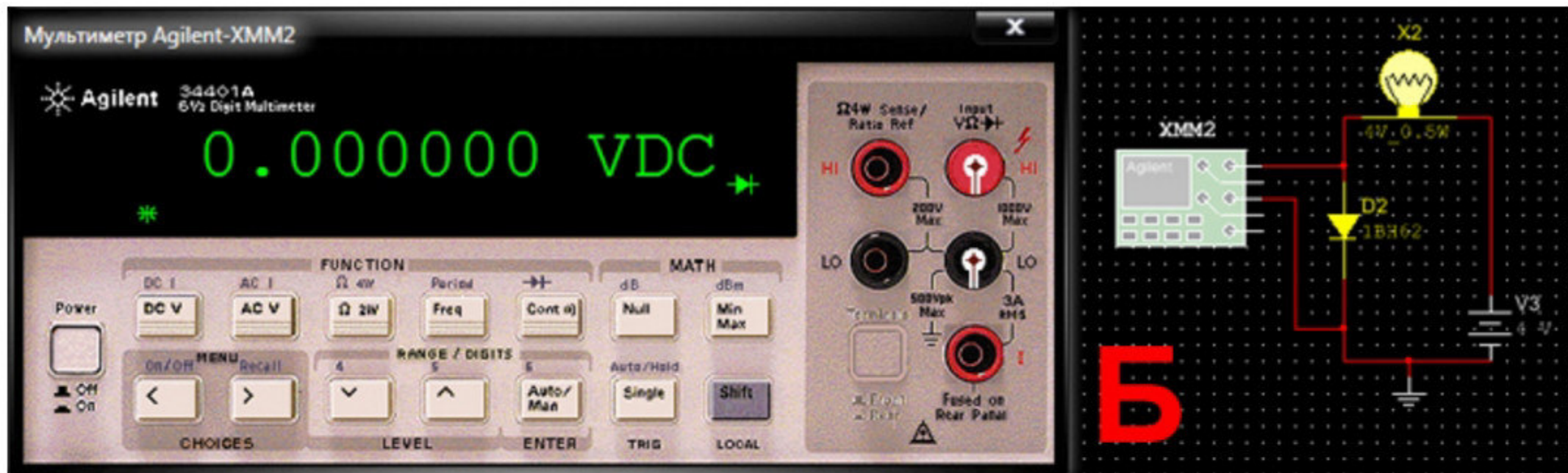
Рис. 5. Испытание диода при помощи мультиметра Agilent: (а) диод открыт, (б) диод неисправен
