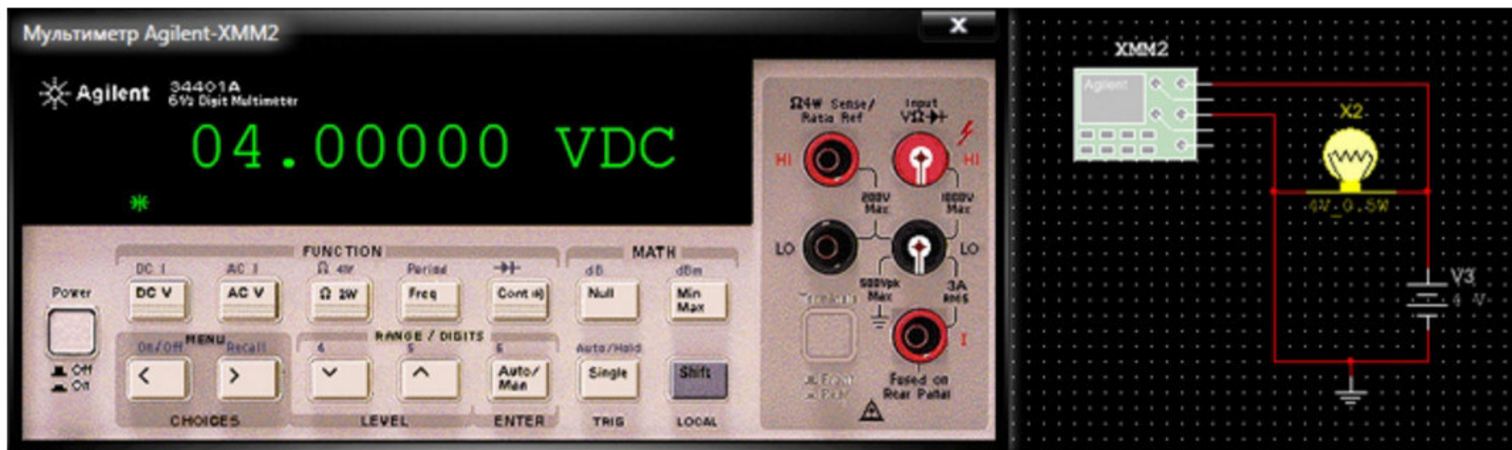
Рис. 3. Измерение напряжения на элементе цепи при помощи виртуального мультиметра Agilent
