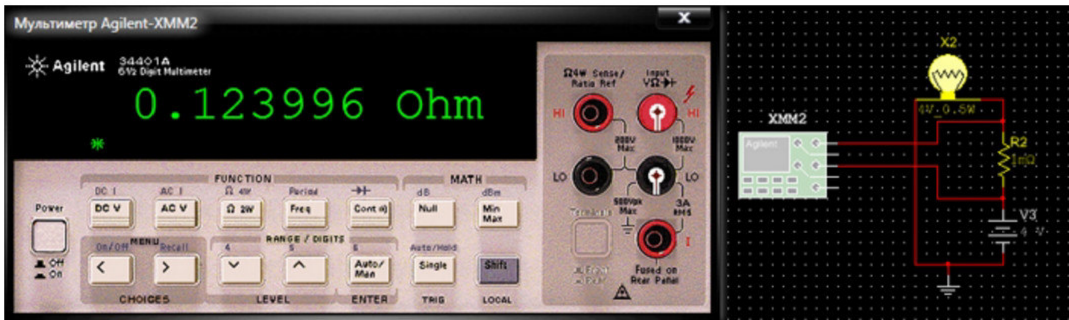
Рис. 4. 2-проводное измерение сопротивления при помощи виртуального мультиметра Agilent
