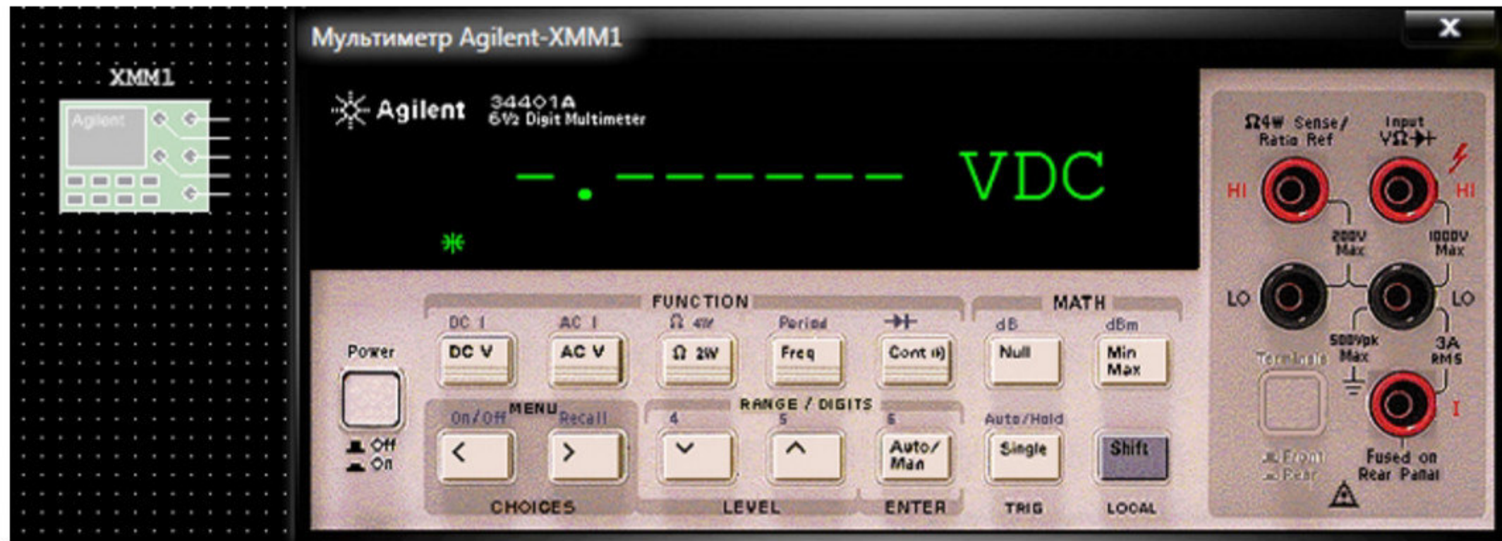
Рис. 1. Пиктограмма виртуального мультиметра Agilent в рабочем поле проекта и его лицевая панель
