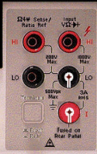
Рис. 2. Измерение тока, протекающего через цепь, при помощи виртуального мультиметра Agilent
