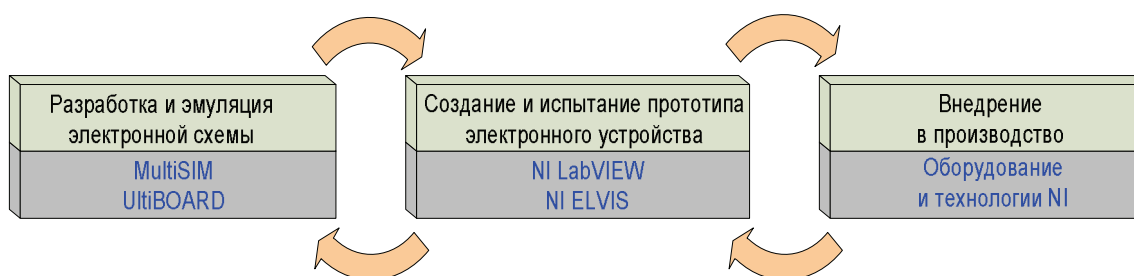
Рис. 2.2. Схема непрерывного цикла разработки электронных устройств
