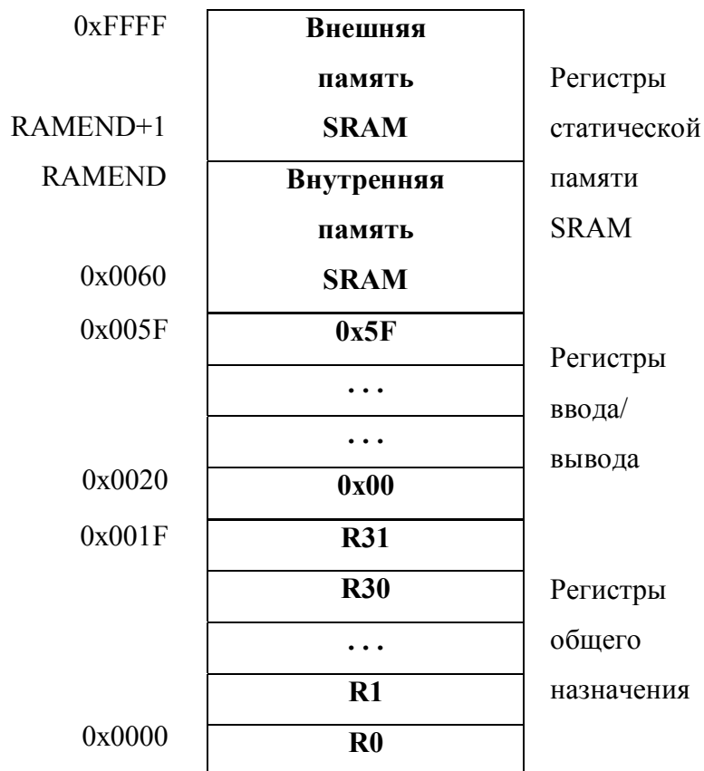
Рис. 8.2. Структура памяти данных в микроконтроллерах AVR
