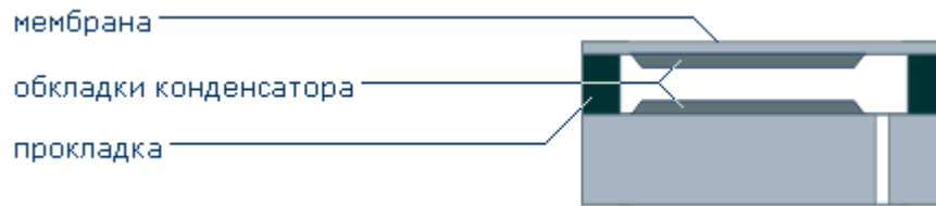
Рис.6 Емкостной керамический преобразователь давления, выполненный методами микромеханики
