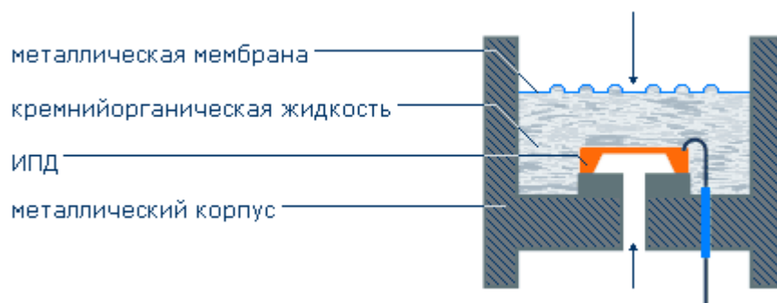
Рис.5 Преобразователь давления защищенный от измеряемой среды посредством коррозионно-стойкой мембраны
