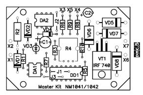
Правильно собранный из исправных деталей регулятор мощности настройки не требует. В терморегуляторе может потребоваться подбор резисторов R3 и R5. От этих резисторов зависит верхняя (R5) и нижняя (R3) границы регулировки температуры. Так как эти значения взаимозависимы, то процедуру подбора нужно повторить несколько раз.
