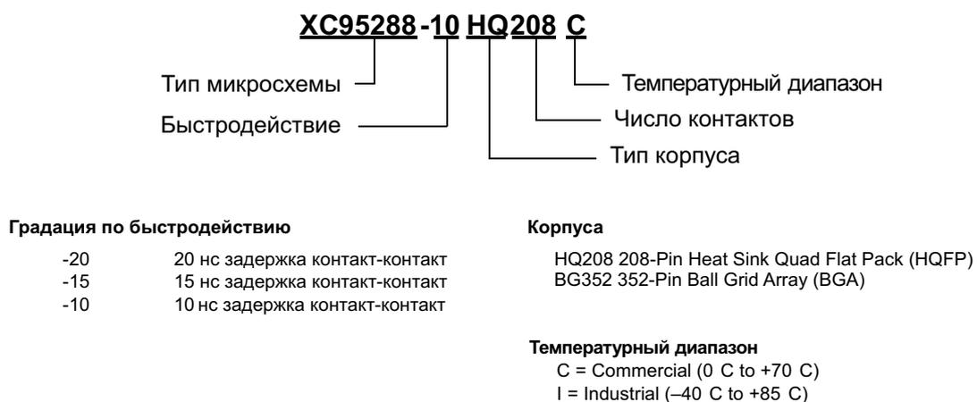
**Рис. 29. Обозначение микросхем XC95288**
