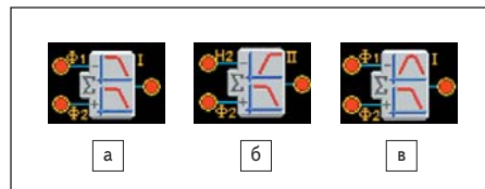
Рис. 36. Условное обозначение сумматора с биквадратичными фильтрами
