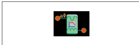
Рис. 33. Условное обозначение выпрямителя с ФНЧ
