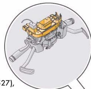
Блок управления электронными приборами на рулевой колонке (J527), на рулевой колонке
