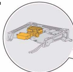
Блок управления двигателем (J623), в правой части воздухоприемного отсека
