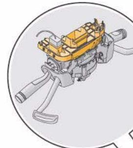
Блок управления автоматической коробкой передач (J217) и блок управления раздаточной коробкой (J646), под сиденьем переднего пассажира
