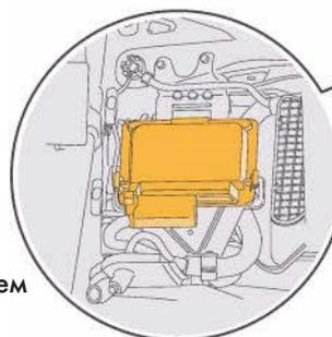
Блок управления АБС с системой стабилизации ESP (J104), в правой части воздухоприемного отсека
