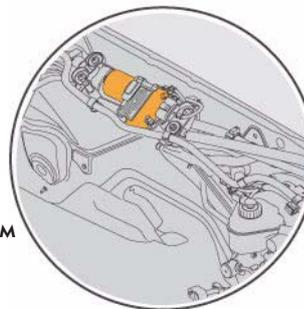
Блок управления двигателем стеклоочистителя (J400), в воздухоприемном отсеке
